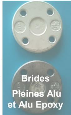
complète de brides plates tournantes en type A et C en AS13 du DN 10 au DN1200 en conformité dimensionnelle avec la gamme PN10 de l'EN1092. Les brides Alu FERRAL sont utilisées dans des domaines d'activité à faible pression de service, comme le traitement de l'eau et offre un avantage indéniable en terme de gain de poids. De plus les prix restent très inférieurs à ceux des brides Inox pour des applications et contraintes identiques.
